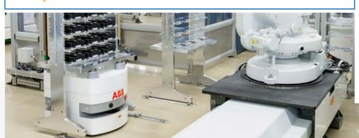
La base del robot mobile BlueBotics mini™ è stata sviluppata per soddisfare le precise esigenze del progetto di automazione della produzione "Genesis" di ABB a Lenzburg, in Svizzera.
